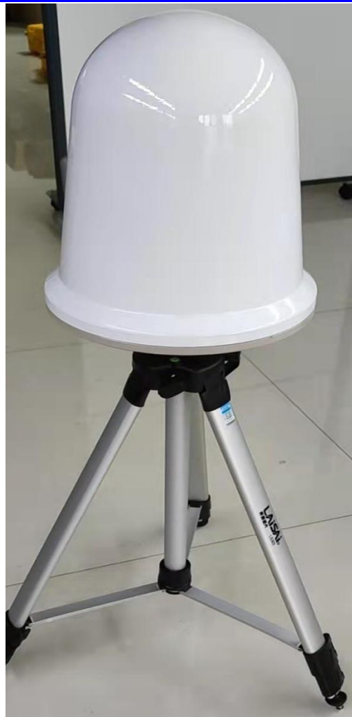
图1-7 BDX-ATYX01天线安装示意图
